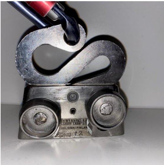
Merkinnät ovat puutteelliset
