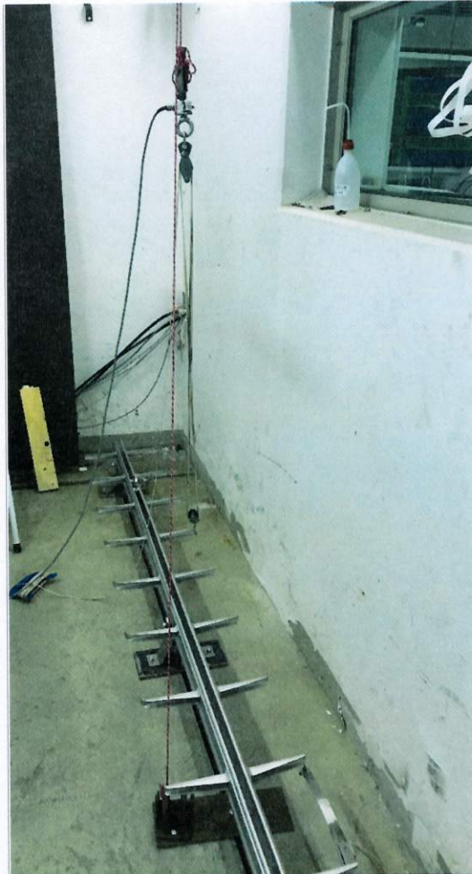
Bild 2: Prüfaufbau für vertikal Belastungsprüfung am Beispiel der Prüfung nach DIN 18799-2:2019 Abschnitt 4.7.4
